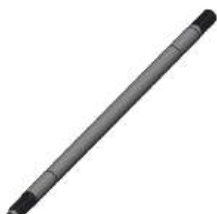
Eixo Ligação Tração Dianteira Comprimento: 696,00mm 22 / 22 Estrias Cód. Alt.: CQ 50411
