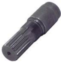
Ponteira Salva-Eixo Pinhão da Tração Diâmetro Ext.: 29,80mm Comprimento: 130,00mm 22 Estrias Aplicação: John Deere 5075
