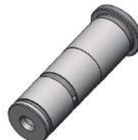
Eixo Engrenagem Satélite Diâmetro Ext.: 25,65mm Diâmetro Total: 31,40mm Comprimento: 86,00mm
