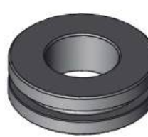
Embolo Cilindro de Direção John Deere 7815 Tração Dana Diâmetro Ext.: (A): 79,50mm Diâmetro Int.: (B): 39,85mm
