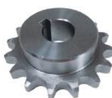
Engrenagem 16 Dentes ASA 60 Furo: 30,00mm
