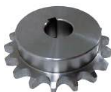
Engrenagem 18 Dentes ASA 60 Furo: 30,00mm
