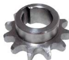
Engrenagem 12 Dentes ASA 60 Furo: 35,00mm
