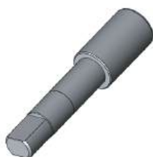
Eixo Intermediário Comprimento: 190,00mm
