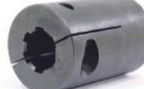
Luva Estriada Acionamento 06 Estrias Diã.(A/B): 35,00 / 30,00mm Comprimento(C): 103,00mm Aplicação: Massey Ferguson MF 6690
