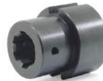
Luva Estriada Acoplamento 06 Estrias Diã.(A/B): 35,00 / 30,05mm Comprimento(C): 76,00mm Aplicação: New Holland 5070
