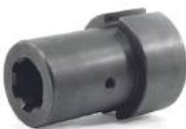
Luva Estriada Acoplamento 06 Estrias Diã.(A/B): 35,00 / 30,05mm Comprimento(C): 105,80mm Aplicação: New Holland 5070
