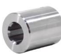
Luva Estriada Acoplamento 06 Estrias Diã. (A/B): 30,00 / 26,00mm Comprimento(C): 65,00mm Aplicação: Graneleiro Boelter
