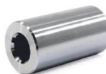
Luva Estriada Acoplamento 06 Estrias Diã. (A/B): 30,00 / 26,00mm Comprimento(C): 100,00mm Aplicação: Implementos Boelter
