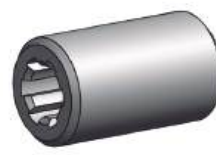
Luva Estriada Acoplamento 06 Estrias Diã. (A/B): 26,70 / 20,00mm Comprimento(C): 70,00mm Aplicação: Case 580 Super H
