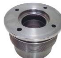
Tampa Cilindro Hidr. Giro Diâ. Externo: 118,80mm Diâ. Interno: 51,00mm Comp. Total: 86,00mm Rosca 12 Fios/Pol Aplicação: Retroescavadeira Case
