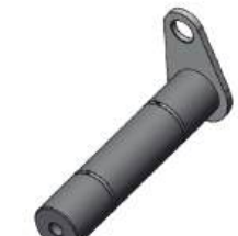
Pino Traseiro Comp. Total: 329,53mm Diâmetro: 70,00mm
