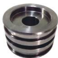
Embolo Cilindro da Lança Diã. Externo: 81,40mm Diã. Interno: 25,60mm Comp. Total: 50,80mm
