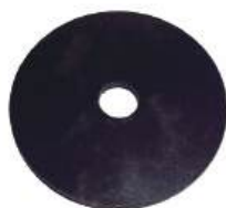
Arruela Eixo Traseiro Diâmetro Ext.: 60,00mm Diâmetro Int.: 11,00mm Espessura: 3,25mm Cód. Alt.: 133742713 Aplicação: Case 580 L
