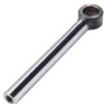
Haste Cilindro de Giro Diâmetro: 50,80mm Comp. Total: 498,90mm Rosca 1 1/4" UNF 12 F/P
