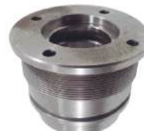
Tampa Cilindro Hidr. Giro Diâ. Externo: 115,00mm Diâ. Interno: 51,10mm Comp. Total: 82,50mm Rosca 12 Fios/Pol Aplicação: Case 580 L
