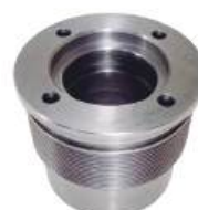
Tampa Cilindro Caçamba Traseira Diã. Externo: 101,60mm Diã. Interno: 78,20mm Comp. Total: 86,00mm Rosca 12 Fios/Pol
