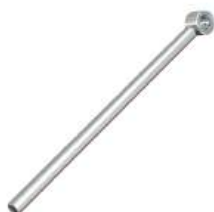
Haste Cilindro da Lança Diâmetro: 57,15mm Comp. Total: 1226,60mm Rosca 1 3/8" 18 Fios
