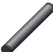
Pino Suspensão Dianteira Comp. Total: 430,00mm Diâmetro: 50,00mm
