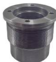
Tampa Cilindro Levante Pá Carreg. Diã. Externo: 99,00mm Diã. Interno: 51,30mm Comp. Total: 86,00mm Rosca 12 Fios/Pol
