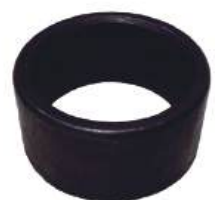
Bucha Pivô Lança Diâmetro Ext.: 63,55mm Diâmetro Int.: 51,10mm Comprimento: 31,75mm Cód. Alt.: 146929 A-1 Aplicação: Case 580 H Case 580 F Case W20/W20D/W20E
