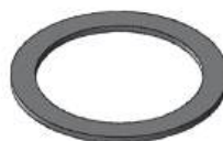
Arruela Calço Pino e Bucha Diâmetro Ext.: 86,00mm Diâmetro Int.: 66,70mm Espessura: 2,70mm Aplicação: Case 580 L
