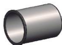
Tubo Comprimento: 100,00mm Diâmetro Ext.: 73,00mm Diâmetro Int.: 66,00mm
