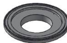
Porta Retentor Diâmetro Ext.: 130,00mm Diâmetro Int.: 63,60mm Espessura: 20,00mm
