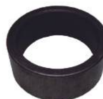
Bucha Pivô Lança Diâmetro Ext.: 63,55mm Diâmetro Int.: 51,15mm Comprimento: 25,40mm Aplicação: Case 580 E
