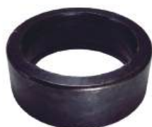
Bucha Mesa de Giro Diâmetro Ext.: 90,00mm Diâmetro Int.: 70,00mm Comprimento: 32,00mm Cód. Alt.: D151069 Aplicação: Retroescavadeira Case
