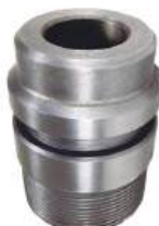
Tampa Cilindro Hidr. Direção Diâ. Externo: 37,85mm Diâ. Interno: 19,15mm Comp. Total: 50,00mm Rosca 1 7/16" 18 F/P Aplicação: Case 580 H
