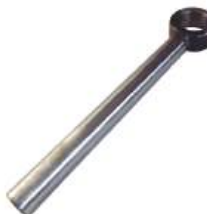
Haste Cilindro de Giro Diâmetro: 50,75mm Comp. Total: 580,00mm Rosca 1" UNF 14 Fios/P
