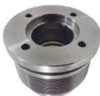
Tampa Cilindro Hidr. Estabilizador Diâ. Externo: 115,00mm Diâ. Interno: 51,00mm Comp. Total: 86,00mm Rosca 12 Fios/Pol Aplicação: Case 580 L Série 3
