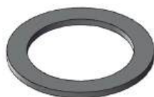
Arruela Calço Pino e Bucha Diâmetro Ext.: 63,40mm Diâmetro Int.: 46,30mm Espessura: 3,00mm Aplicação: Case 580 L
