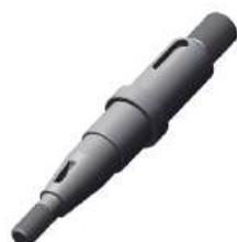
Eixo Transmissão Comp. Total: 171,00mm Rosca M12 x 1,75 Rosca M18 x 1,5 28 Estrias
