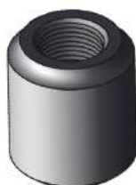
Olho Cilindro de Direção Com Rosca Rosca 1 1/16" UNF 18 F/P Comp. Total: 35,00mm
