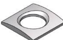
Arruela Diâmetro Ext.: 55,00mm Diâmetro Int.: 32,50mm Espessura: 7,00mm
