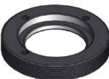
Tampa Diâmetro Ext.: 101,40mm Diâmetro Int.: 58,00mm Espessura: 17,00mm Rosca 20 F/P
