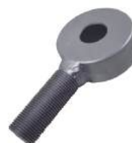
Olho Ponta de Haste Rosca Esquerda Rosca 7/8" UNF 14 F/P
