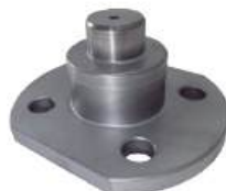
Pino Pivô Tração Comp. Total: 49,50mm Diâmetro: 25,02mm Diâmetro: 40,00mm Cód. Alt.: 85805983
