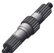
Eixo Transmissão Comp. Total: 330,00mm 15/21/15 Estrias
