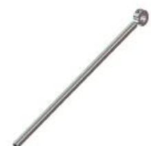
Haste Cilindro Levante da Lança Diâmetro: 44,45mm Comp. Total: 1296,60mm Rosca 1" UNF 14 Fios/P
