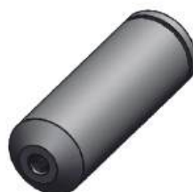
Pino Traseiro Comp. Total: 150,00mm Diâmetro: 50,80mm Rosca: M12 x 1,75
