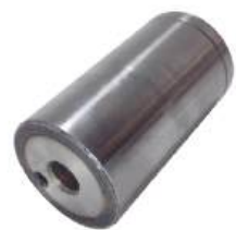
Pino Caixa Satélite Comp. Total: 72,50mm Diâmetro: 40,00mm Eixo Traseiro Redução Final
