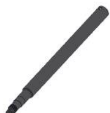
Eixo Transmissão Comp. Total: 440,00mm 36 Estrias Rosca 5/8" UNC 11 F/P
