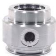
Tampa Cilindro Hidr. Direção Diâ. Externo: 74,00mm Diâ. Interno: 36,05mm Comp. Total: 59,00mm Aplicação: Case 580 M
