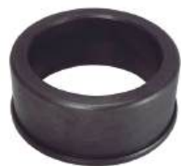
Bucha Traseira Diâmetro Ext.: 90,05mm Diâmetro Int.: 70,20mm Comprimento: 38,00mm
