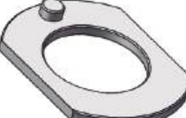
Arruela Diâmetro Ext.: 65,00mm Diâmetro Int.: 36,00mm Espessura: 4,00mm
