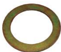
Arruela Eixo Traseiro Diâmetro Ext.: 77,80mm Diâmetro Int.: 55,40mm Espessura: 2,70mm Aplicação: Case 580 N
