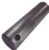
Pino Caçamba Dianteira Comp. Total: 138,00mm Diâmetro: 38,10mm Cód. Alt.: E157390
