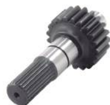
Eixo Acionador Tração Comprimento: 181,00mm 21 Dentes / 24 Estrias Cód. Alt.: 3603220 M-1
